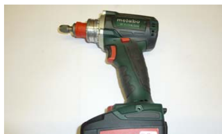
Testa di perforazione utilizzabile con vari inserti ad attacco rapido
