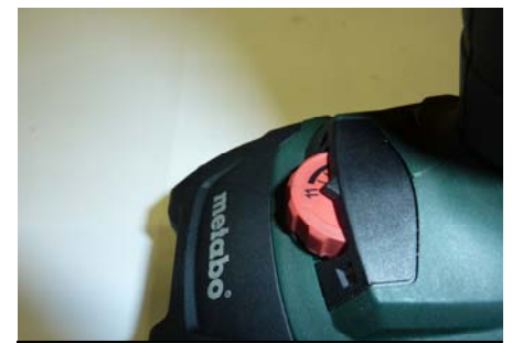
Impostare l'avvitatore su velocità 11.
