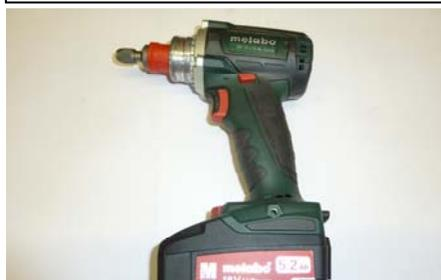
Aufsetzbare Aufnahme für verschiedene Schraubeinsätze mit Rapidanschluss.
