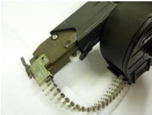
3. Probe Schraubungen durchführen. Im Fall dass das Führungsblech die Schraubengurte bremst, die M5 Schraube ein bisschen lockern.
