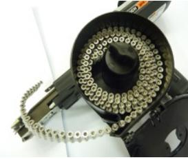
1. Rolle einfügen und Decke Schließen.
