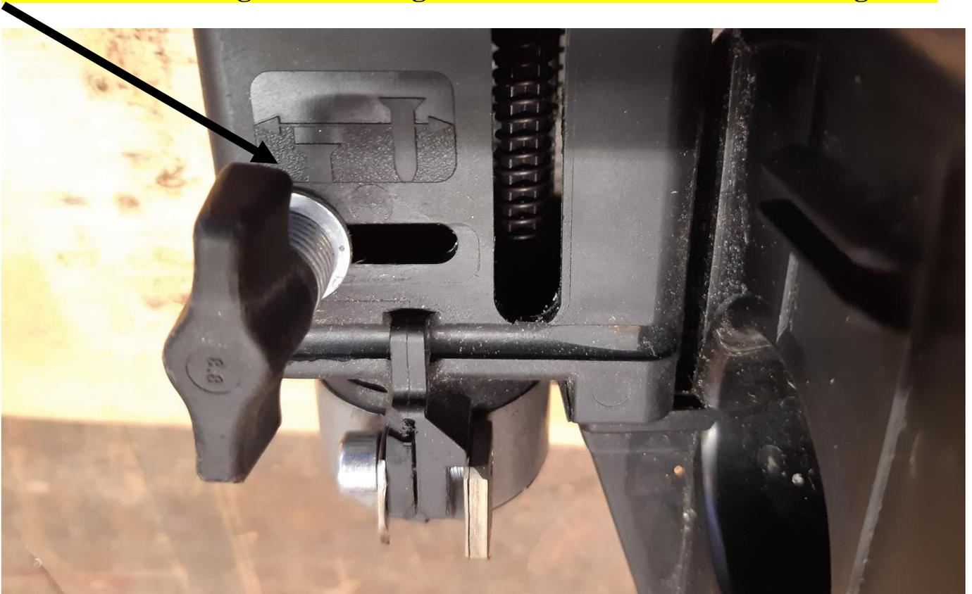
**Wird die Eindringtiefe der Schraube auf maximal eingestellt so wird das Gewinde im Holz überdreht, bzw. wird vom Untergrund ausgerissen und die Auszugskraft kann nicht mehr gewährleistet werden. Außerdem verschleißt oder wird der Werkzeugdorn M5 beschädigt, bekommt Risse und zusätzlich wird das Getriebe beschädigt ( siehe Foto unten ).**
