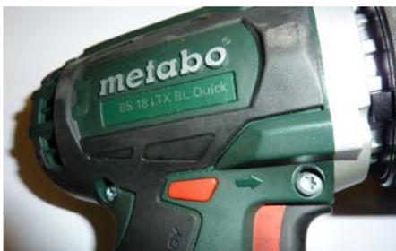
Rechtsdrehung=mit Pfeilrichtung zum Schraubfuß.
