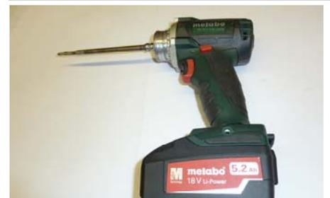
Aufsetzbarer Werkzeugdorn mit Einsatz BT.
