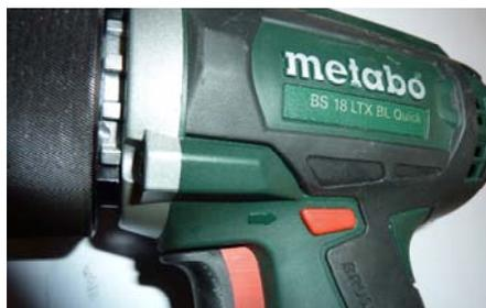
Linksdrehung=mit Pfeilrichtung zum Hinterteil
